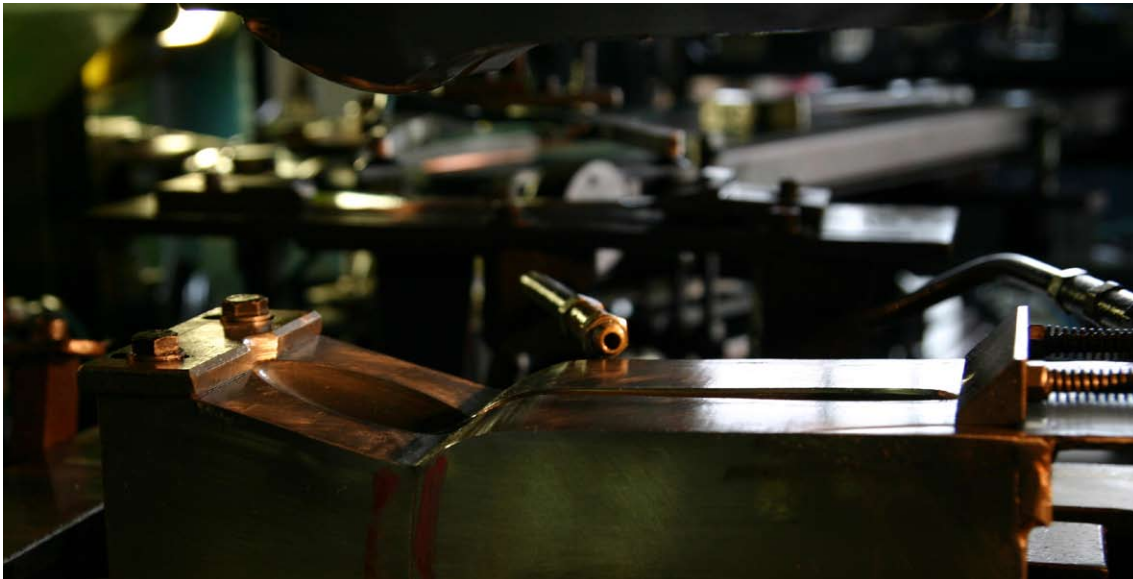
Uno stampo di posata Salvinelli posizionato nella pressa
