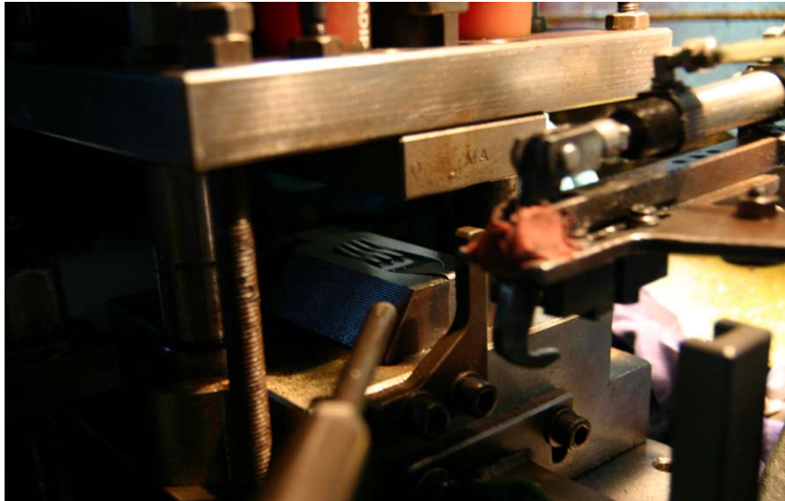
Fase della lavorazione Tranciatura rebbi della forchetta
