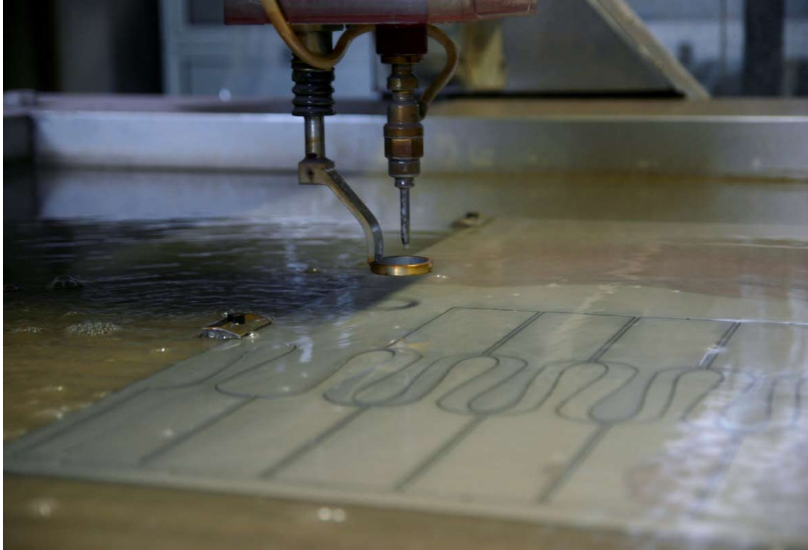
Taglio ad acqua e sabbia Utilizzato per creare piccole quantità di posateria. Questo evita gli alti costi di produzione degli stampi
